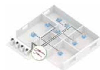
Sistema VRF - Pompa di calore 2 tubi
