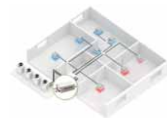
Sistema VRF - Pompa di calore 3 tubi
