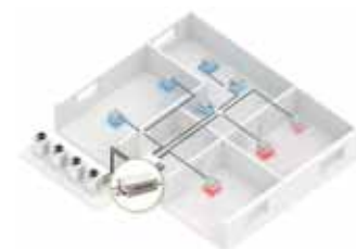
Système VRF - Pompe à chaleur à 3 tuyaux
