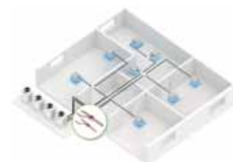
Système VRF - Pompe à chaleur à 2 tuyaux
