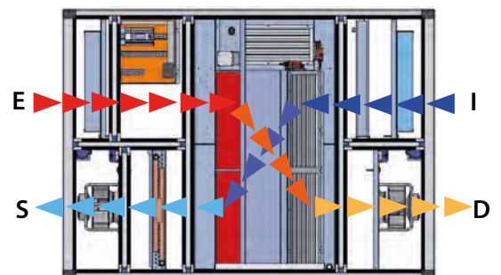
RPF Z Configuration Verticale refoulement à gauche (vue du coté accessible)
