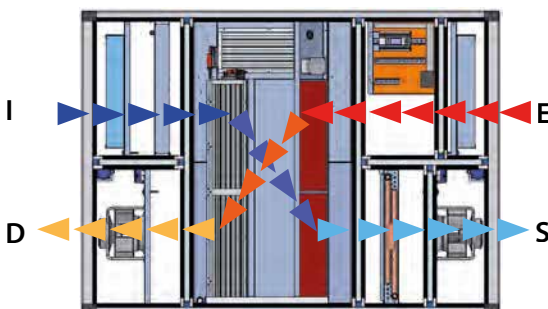
RPF V Configuration Verticale refoulement à droite (vue du coté accessible)
