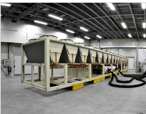
Installations d'essai Aermec à 2MW
