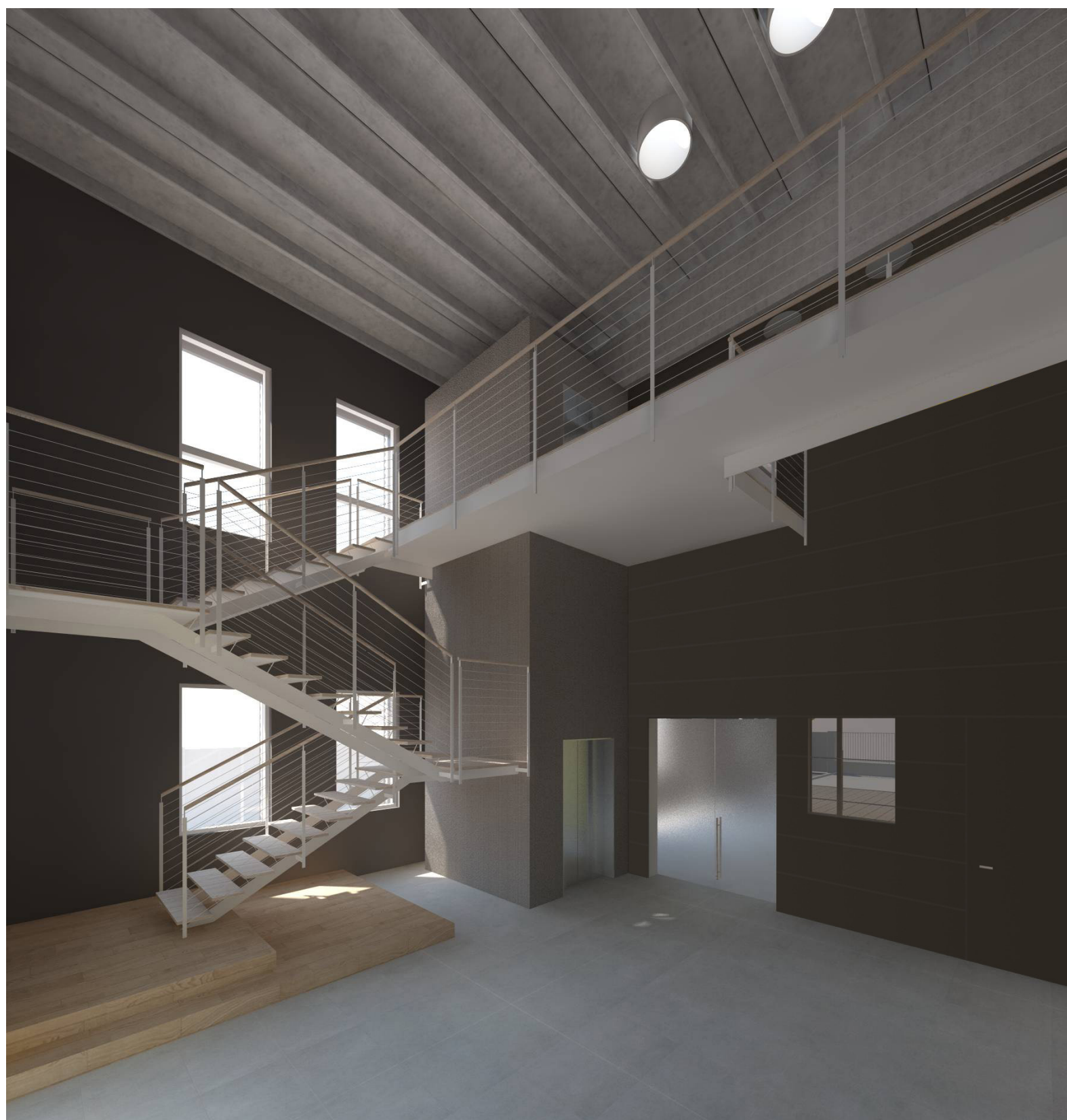
Vista dell nuovo ingresso agli uffici, in cui la struttura prefabbricata viene lasciata a vista e costituisce lo sfondo architettonico ai nuovi elementi progettuali.
