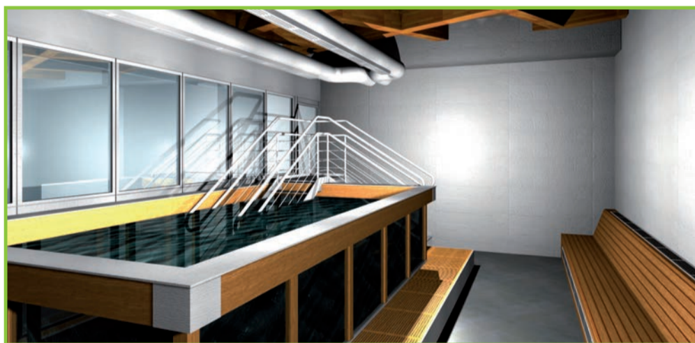
Vista della palestra con vasca per idroterapia. I canali di areazione sono dissimulati nella seduta e nello schienale della panca in teak.
