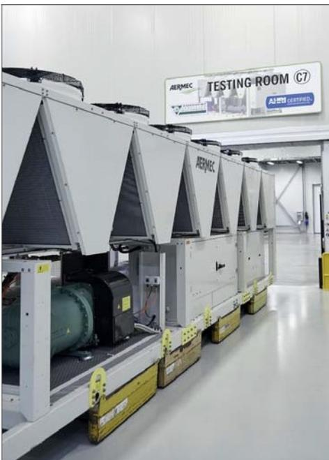
Représentant un investissement de 5 M€, la nouvelle chambre permet de tester des unités d'une puissance de chauffage et de refroidissement allant jusqu'à 2000 kW et mesure 28 m de long par 6 m de haut pour un volume total de 2200 m<sup>3</sup>.
