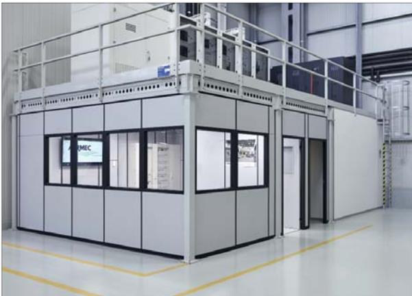
Besonderes Augenmerk kam den Tests im Beisein der Kunden zu: einer ständig wachsenden Anforderung für Großprojekte. Die neuen Testlabors verfügen über einen eigenen Beobachtungsraum für Tests im Beisein der Kunden. Dort können diese sämtliche Parameter in Echtzeit überwachen und aufzeichnen, besondere Kundenanforderungen rasch implementieren lassen und den Betrieb bequem beobachten.
