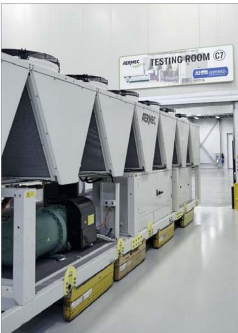
Die neue Kammer stellt eine € 5m Investition dar und ermöglicht Tests an Geräten mit Kühl- und Heizleistungen bis 2.000 kW. Sie ist 28 m lang, 6 m hoch und besitzt ein Gesamtvolumen von 2.200 m<sup>3</sup>.
