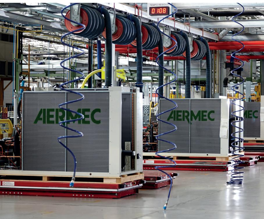
Linea di montaggio di macchine di media potenza
