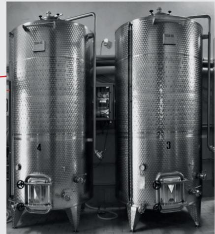
Le choix de la machine a été déterminé par la quantité de moût à traiter (100 hectolitres), par la température (19°C) et par le temps requis pour la fermentation et par la dispersion thermique à travers les parois de la cuve selon les formules suivantes:
