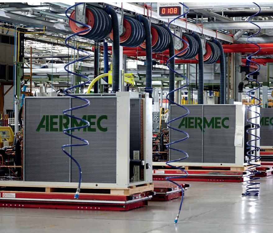
Cadena de montaje de máquinas de potencia media
