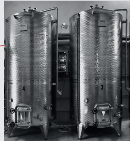
La elección de la máquina vino determinada por la cantidad de mosto que había que tratar (100 hectolitros), por la temperatura (19 °C), por el tiempo necesario para la fermentación y por la dispersión térmica a través de las paredes del tanque según las siguientes fórmulas
