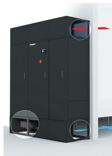
Esecuzione per installazione all'esterno del data center, senza pavimento sopraelevato e mandata posteriore. In questo caso il supporto di altezza fissa 550 mm, è fornito di pannelli di chiusura laterali e griglie di mandata posteriori. L'installazione del plenum con sistema di aspirazione posteriore è opzionale, in mancanza di un sistema di canalizzazione.
