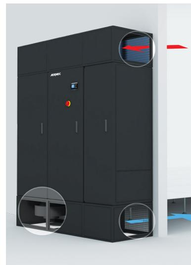
Ausführung für die Installation außerhalb des Datenzentrums, ohne Installationsboden und rückwärtigen Luftauslass. In diesem Fall wird der Sockel mit fester Höhe von 550 mm mit seitlichen Verschlussplatten und rückwärtigen Luftauslassgittern geliefert. Die Installation des Plenums mit rückwärtigem Ansaugsystem ist optional, bei fehlendem Kanalisierungssystem.
