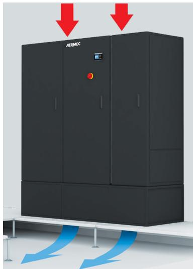
Ausführung für umlaufende Installation im Innern des Datenzentrums mit weniger als 550 mm hohem Installationsboden. In diesem Fall muss der Sockel mit einer festen Höhe von 550 mm, der mit seitlichen Verschlussplatten geliefert wird, oberhalb des Fußbodens installiert werden. Die Höhe der Decke muss jedoch unbedingt die einwandfreie Absaugung der Luft ermöglichen.
