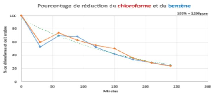
Test comparatif sur des photocatalyseurs pour la réduction des polluants COV
