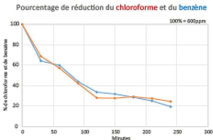
Test comparatif sur des photocatalyseurs pour la réduction des polluants COV
