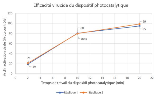
Valeurs d'inactivation en fonction de la variation du temps de travail du dispositif photocatalytique lors des 6 tests effectués
