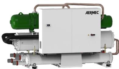
WFGI es la bomba de calor agua-agua con compresores de tornillo que utiliza el nuevo gas ecológico R1234ze con GWP 7 y alternativamente el gas ecológico R515B también perteneciente a la clase de seguridad A1 según ISO817 (no tóxico, no inflamable).
