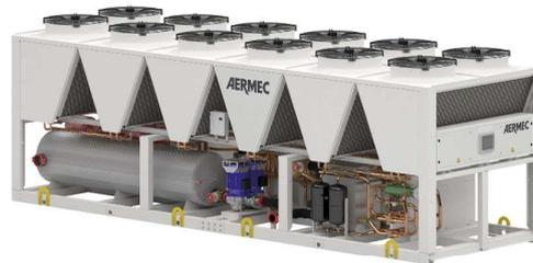
La machine standard est alignée, aux conditions de projet, à la puissance thermique requise par l'installation pendant la saison hivernale (380 kW), tandis qu'en ce qui concerne la saison estivale, elle est surabondante : à 35°C de l'air extérieur, elle garantit une puissance réfrigérante de 502 kW.
