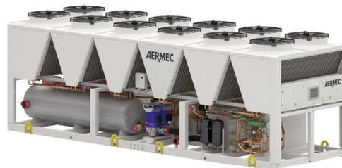
Das Standardaggregat ist unter Auslegungsbedingungen auf den Wärmebedarf der Anlage in der Winterjahreszeit (380 kW) ausgerichtet, während es in der Sommerjahreszeit überdimensioniert ist: Bei 35 °C Außenlufttemperatur garantiert es eine Kühlleistung von 502 kW.
