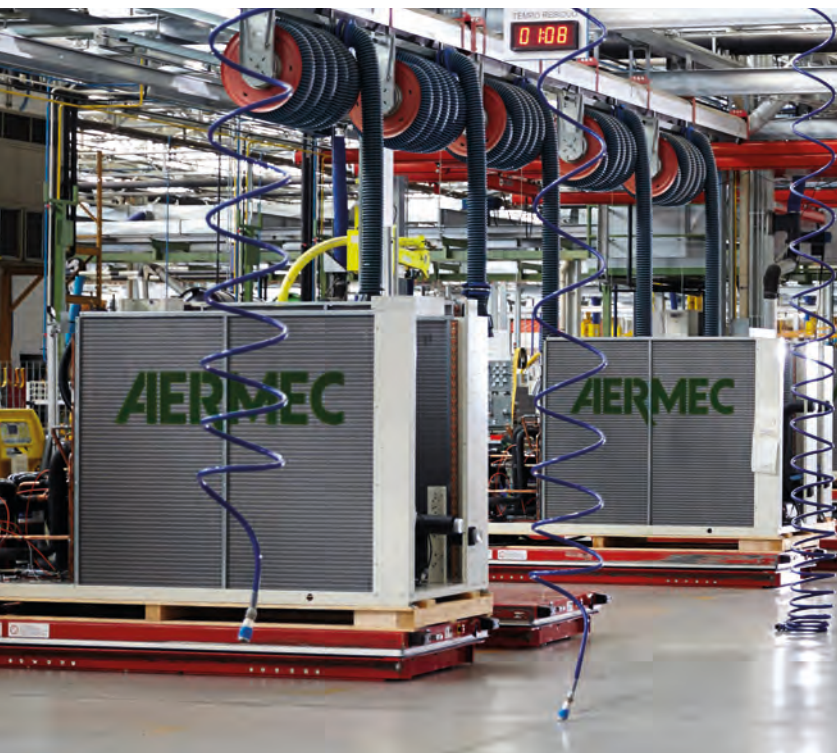
Ligne de montage de machines ayant une puissance moyenne
