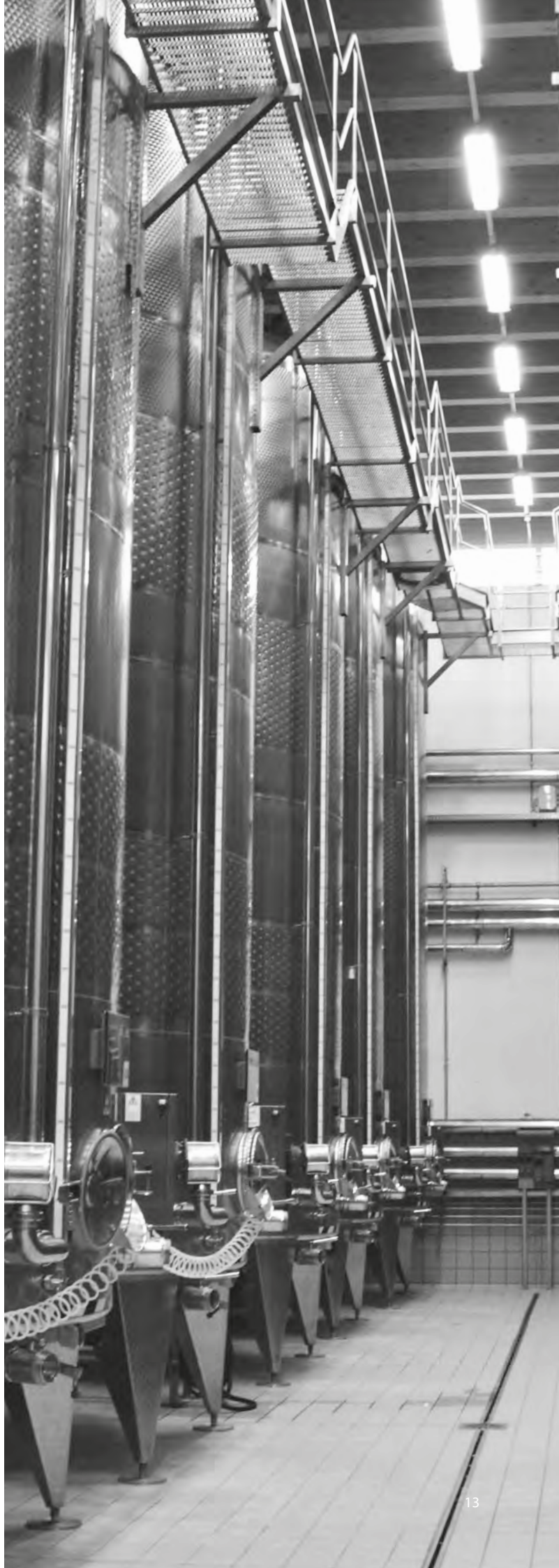
Cave Vivallis. Cuves avec chemises d'échange thermique pour le contrôle de la température.
