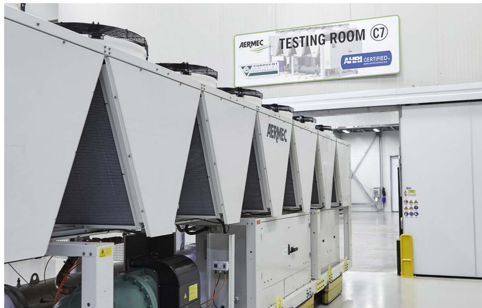
Cámara calorimétrica utilizada también para efectuar pruebas de certificación Eurovent
