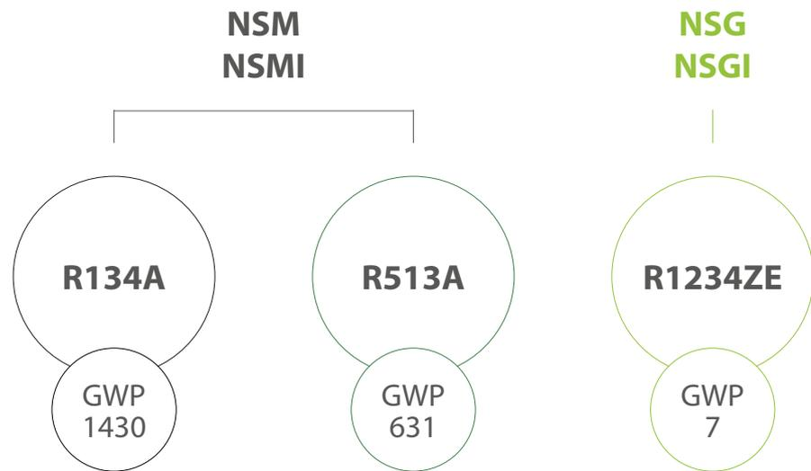
In diesem Zusammenhang bietet Aermec (ein nach ISO 14001 zertifiziertes Unternehmen), das sich seit jeher für Nachhaltigkeit und eine geringere Umweltbelastung einsetzt, die Produktreihen **NSG - NSGI** an, die mit größter Sorgfalt entwickelt wurden, um einen **optimierten Betrieb mit HFO R1234ze-Gas mit einem GWP nahe 1 zu gewährleisten**.
