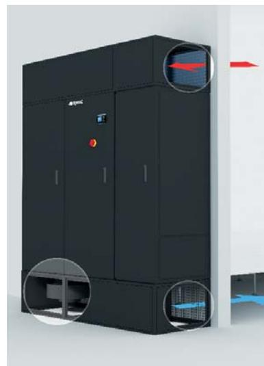
Exécution pour installation à l'extérieur du data center, sans sol surélevé et refoulement postérieur. Dans ce cas, le support de hauteur fixe 550 mm est fourni de panneaux de fermeture latéraux et de grilles de refoulement arrière. L'installation du plenum avec système d'aspiration arrière est en option, en absence d'un système de canalisation.
