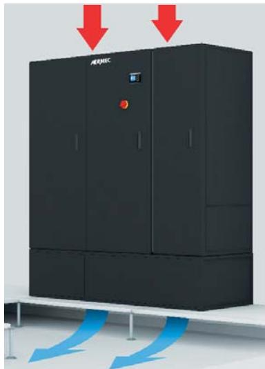
Exécution standard pour installation périmétrale à l'intérieur du data center avec hauteur du sol surélevé minimale de 550 mm. Dans ce cas, le support de hauteur fixe 550 mm, fourni de panneaux de fermeture latéraux, devra être installé sur le sol. Il est toutefois indispensable de vérifier que la hauteur du plafond permet une bonne aspiration de l'air.
