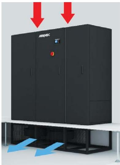
Exécution standard pour installation périmétrale à l'intérieur du data center: Le sol surélevé doit avoir une hauteur minimale de 550 mm.
