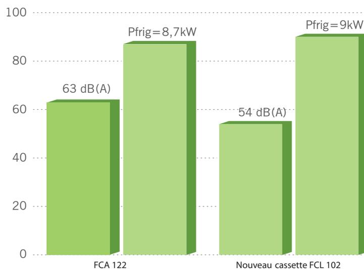
Nótese cómo, en igualdad de caudal de aire, los nuevos fan coils Cassette FCL/FCLI son mucho más silenciosos y producen una mayor potencia de refrigeración con respecto a los viejos modelos FCA. Este resultado se ha obtenido con la optimización de los flujos aerúlicos y gracias a la batería térmica de triple curvatura, teniendo mayor superficie de intercambio con respecto a la vieja batería de simple desarrollo circular.
