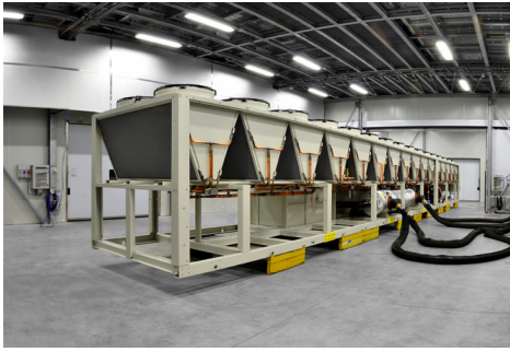
Installations d'essai Aermec à 2MW
